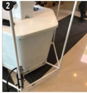
2.写真のように結束バンド2本で支柱に固定していきます。
