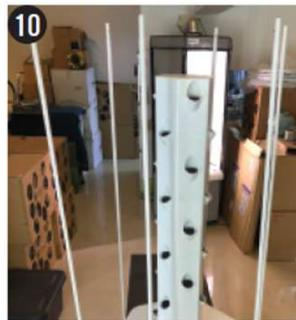
10. 残っている両側メスロッド6本を同様に先ほど取り付けた両側オスロッドの上から差し込みます。
