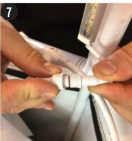
3. コネクタを接続後にロックリングをねじ込み固定します。
