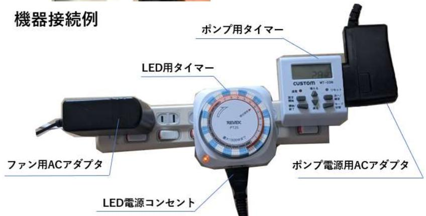
※ポンプ試運転時に動作しない場合は AC アダプタの向きを逆にしてください。
